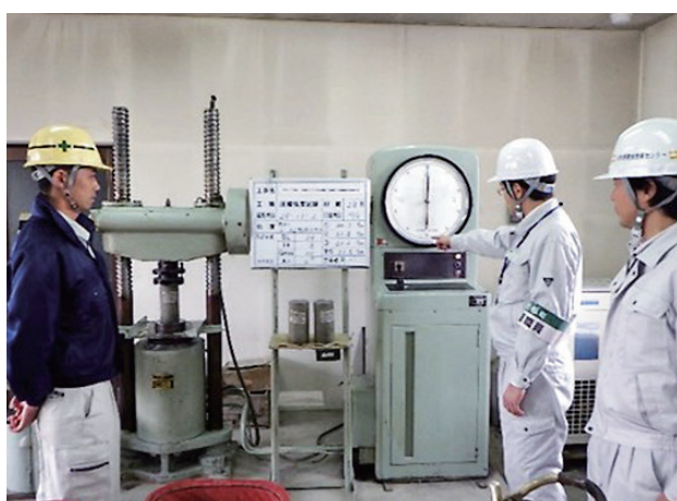
工事現場監督 (コンクリート強度確認)
